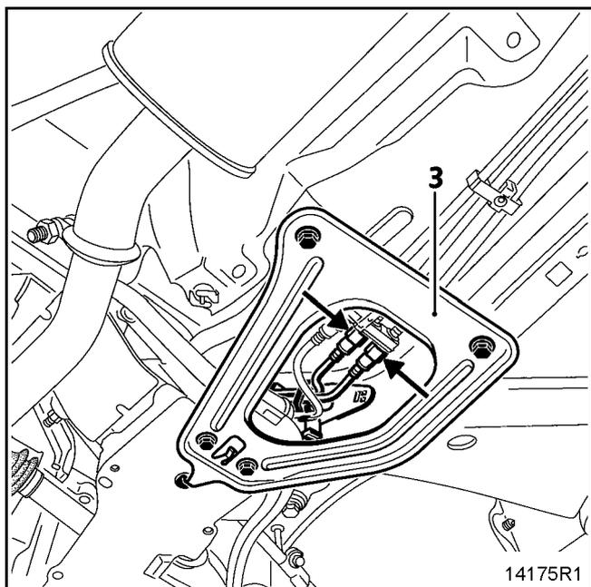
Опустите мост до соприкосновения с подрамника с приспособлением **Mot. 1390**.
