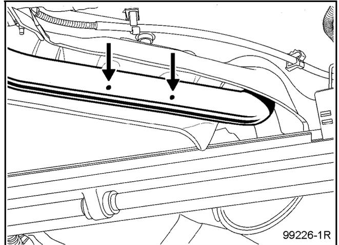
На выпускном трубопроводе имеется зона резки, расположенная между передним глушителем и основным глушителем.
