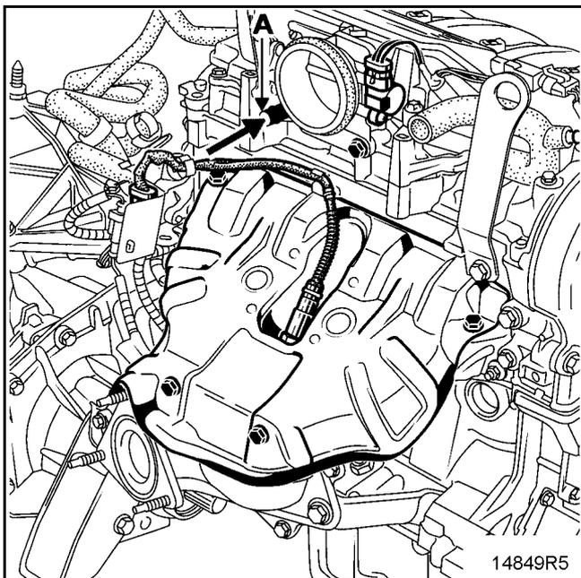
Маслоотделитель расположен на крышке головки блока цилиндров.
