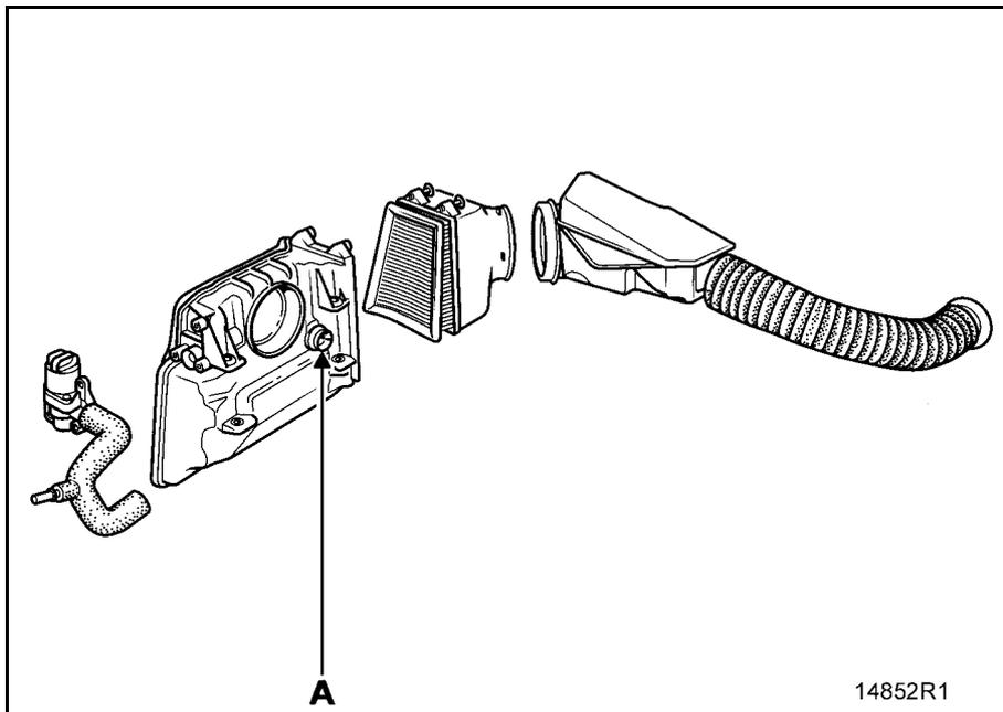
Выходное отверстие системы вентиляции картера.
