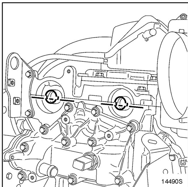
Зафиксируйте приспособление **Mot. 1496** на торцах распределительных валов.
