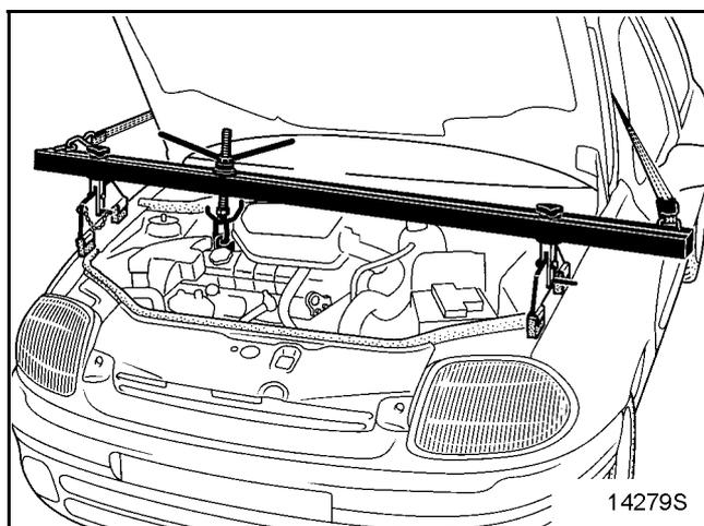
**ПРИМЕЧАНИЕ:** в ходе операции следите за тем, чтобы установочные лапы опорной переключины для вывешивания двигателя были установлены на жестких частях крыльев.
