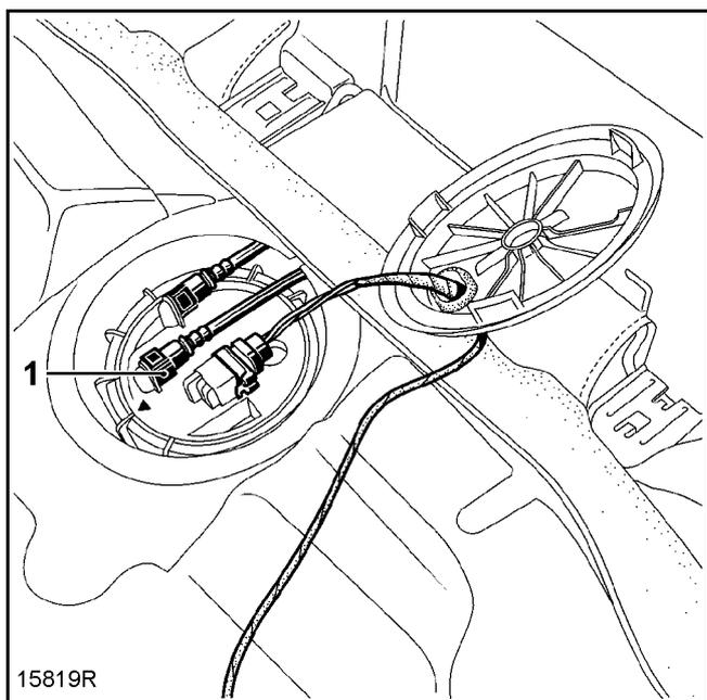
Присоедините к выходному штуцеру насоса трубку длиной достаточной для того, чтобы ее можно было погрузить в емкость вне автомобиля.
