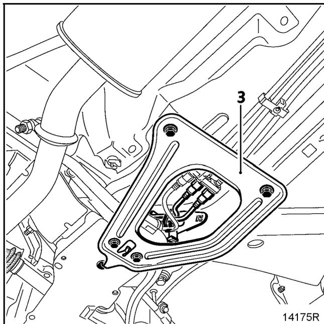
Постепенно опустите подрамник с помощью резьбовых стержней **Mot. 1233-01** до получения приблизительного разреза  $X_1 = 9$  см.
