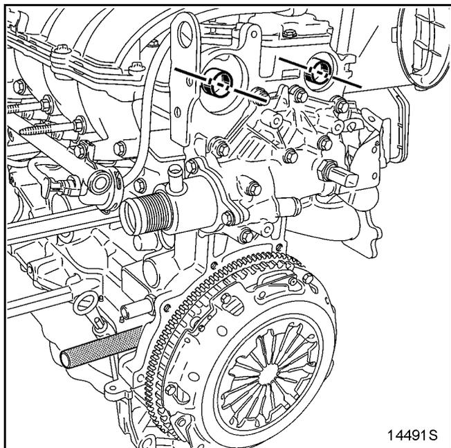
Вверните фиксатор ВМТ **Mot. 1489**, затем медленно и без рывков проверните коленчатый вал на один оборот по часовой стрелке (если смотреть со стороны привода ГРМ), пока вал не встанет на фиксатор.
