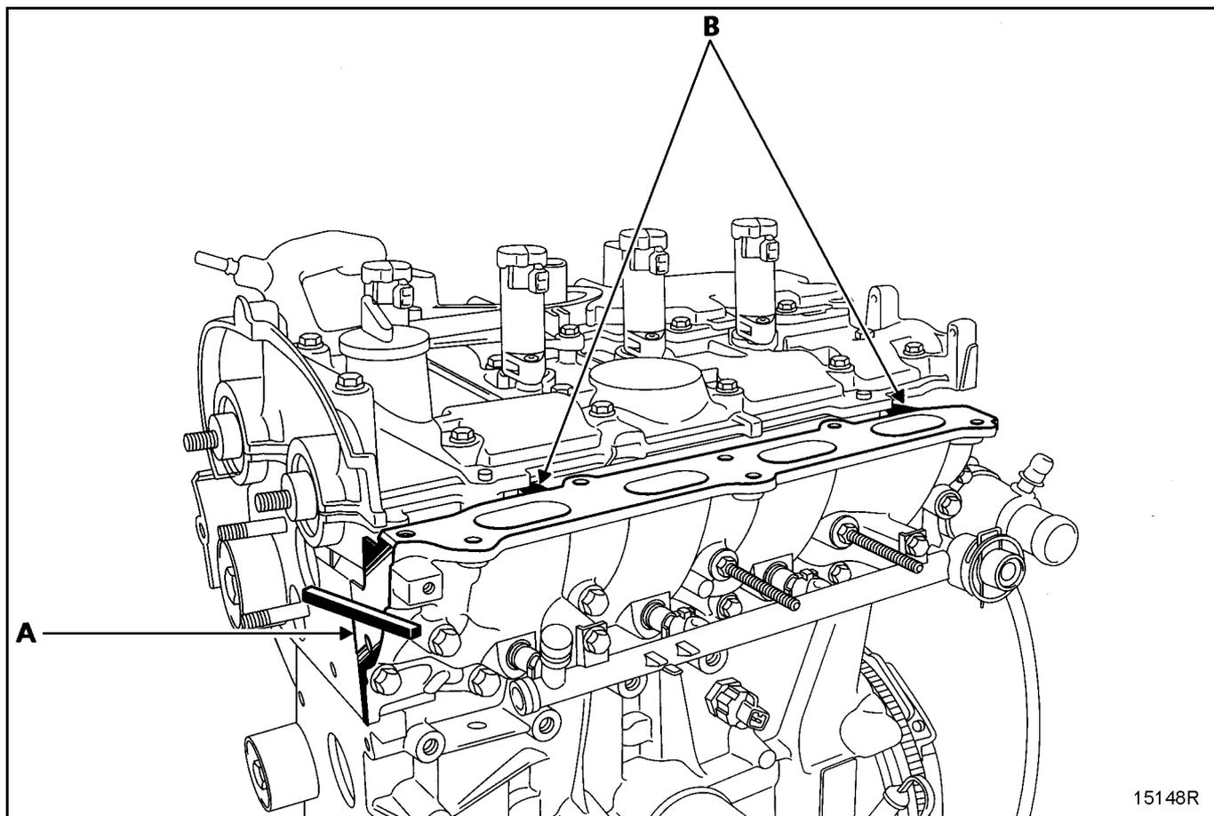
Момент затяжки гаек шпилек крепления нижней части впускного коллектора **2,1 даН.м.**
