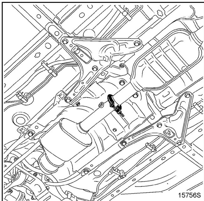
Отсоедините каталитический нейтрализатор от трубы основного глушителя.
