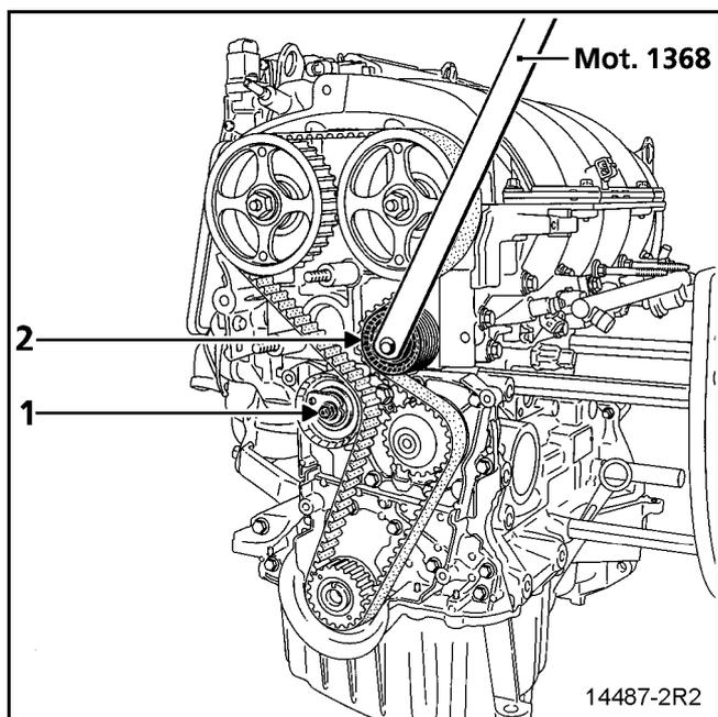
**ВНИМАНИЕ:** необходимо обезжирить носок коленчатого вала, отверстия зубчатого шкива распределительного вала и опорные поверхности шкива коленчатого вала, чтобы избежать проскальзывания между газораспределительным механизмом и коленчатым валом, которое может привести к выходу двигателя из строя.
