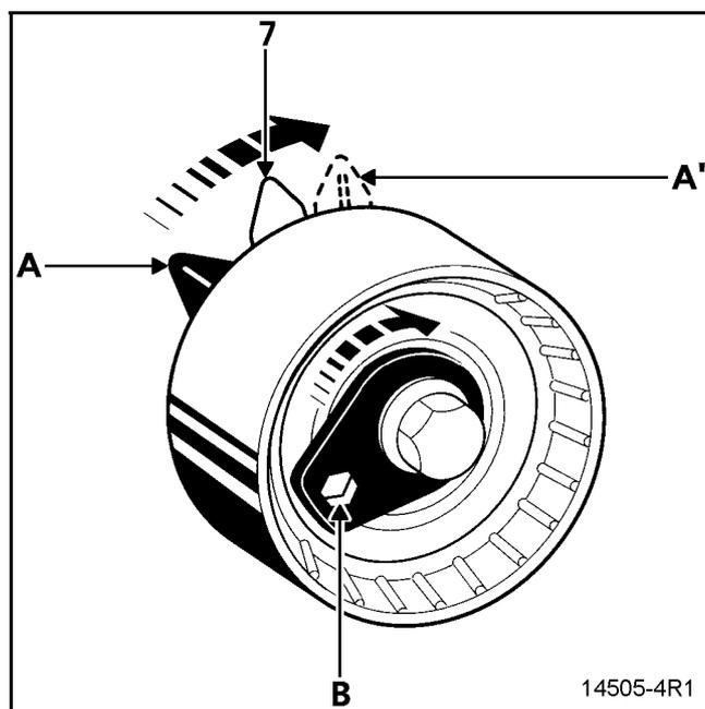
Предварительно затяните гайку крепления оси натяжного ролика моментом **0,7 даН.м**.
